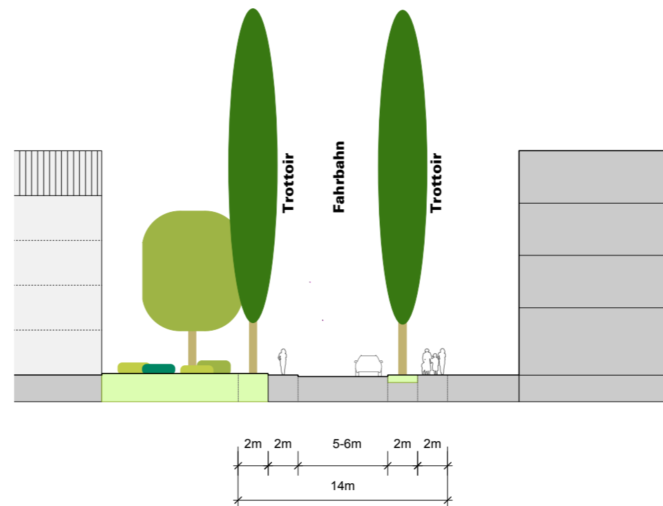
Prinzipquerschnitt SüdAllee, Abschnitt Altsagenstrasse (Richtung Norden)
